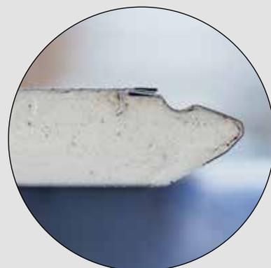
Les panneaux des portes de garage sectionnelles et latérales sont composés de 2 feuillards en acier repliés qui recouvrent la mousse isolante. Ce repliage permet une protection de votre porte et de l'ouverture des panneaux.
